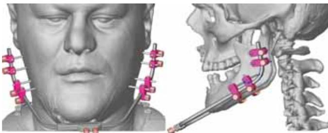
Рис. 2. Виртуальное моделирование для изготовления индивидуального полифункционального аппарата
