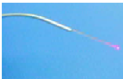
Рис. 2. Гибкий эндодонтический световод (200 мкм)
