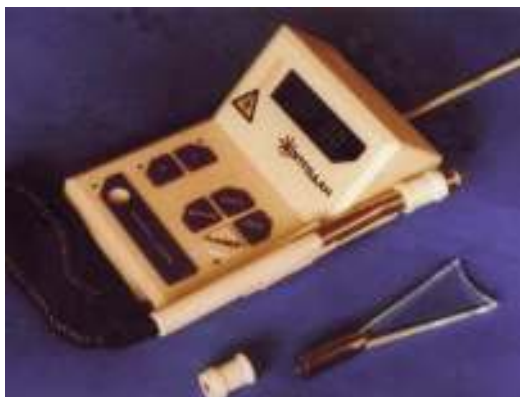
Рис. 1. Стоматологический полупроводниковый диодный лазерный аппарат "Оптодан" со стоматологической и магнитными насадками
