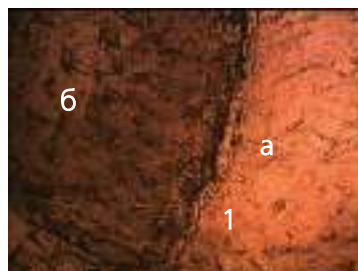
Рис. 7. Поверхность образцов после 750 циклов: 1 — этиленвинилацетат, 2 — полиуретан; а — неповрежденная область, б — поврежденная область. Увеличение \times 100
