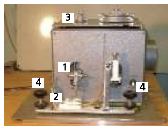
Рис. 1. Установка для проведения механических испытаний знакопеременными нагрузками: 1 — подвижный механизм с металлическим стержнем для испытания на удар; 2 — гидравлическая система определения силы воздействия; 3 — набор шестеренок для изменения частоты ударов и колебаний; 4 — винты регулировки высоты столка
