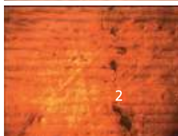
Рис. 7. Поверхность образцов после 750 циклов: 1 — этиленвинилацетат, 2 — полиуретан; а — неповрежденная область, б — поврежденная область. Увеличение \times 100
