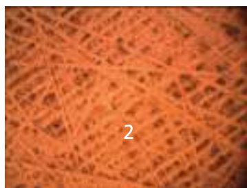
Рис. 6. Поверхность образцов после 250 циклов: 1 — этиленвинилацетат, 2 — полиуретан; а — неповрежденная область, б — поврежденная область. Увеличение \times 100
