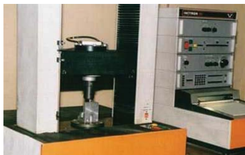
Рис. 5. Рабочий блок универсальной испытательной машины "Instron"
