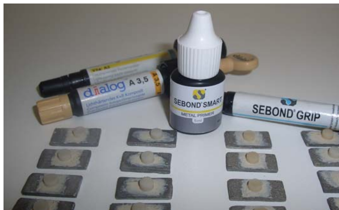
Рис. 2. Подготовленные образцы облицовки кобальтохромового сплава гелиокомпозитом "DIALOG" (SCHUTZ DENTAL GROUP — Германия) с различными адгезивными системами
