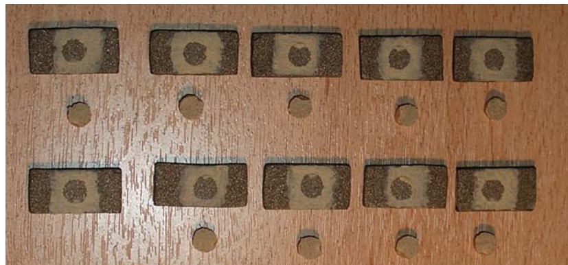
Рис. 6. Зона отрыва композита от металлических пластин
