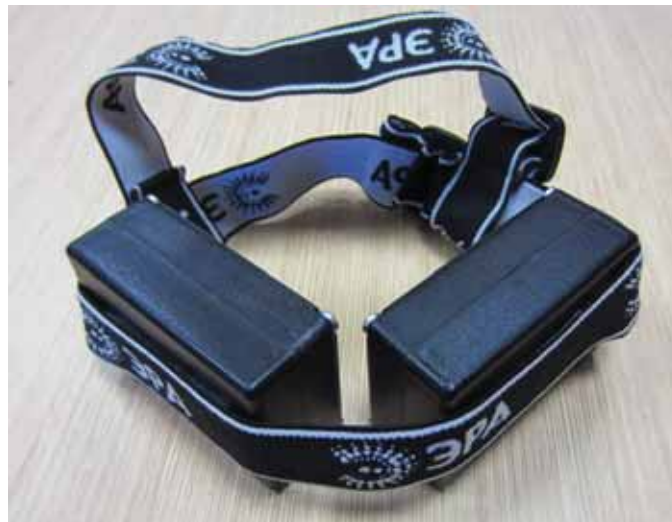
Рис. 1. Опытный образец устройства регистрации перемещения нижней челюсти
