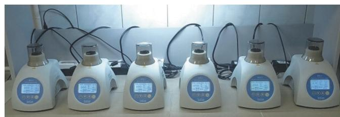
**Рис. 1.** Система программированного культивирования микроорганизмов «Реверс-Спиннер RTS-1» (BioSan, Латвия)
