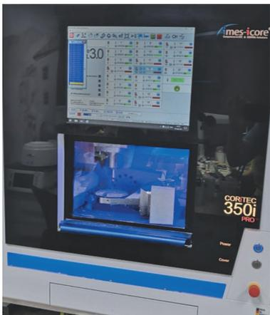
Рис. 7. Этап фрезерования временной конструкции на станке Coritec350i
