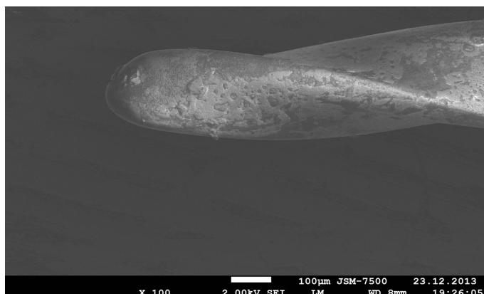
**Рис. 6.** Использованный инструмент "One Shape" (Micro-Mega) France верхушечная часть, вид сбоку (РЭМ ув. 100x)
