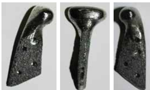
Рис. 1. Эндопротез головки нижней челюсти из никелида титана
