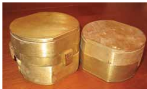
Рис. 2. Зуботехническая кювета в сборе с расширительным кольцом выше стандартной кюветы на 15 мм
