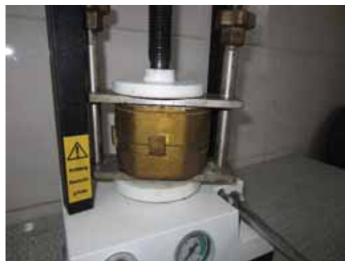
Рис. 7. Кювета в сборе с расширительным кольцом выдерживается в прессе по общепринятой методике
