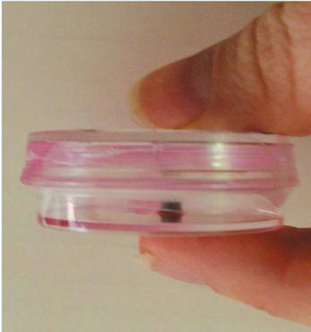
**Рис. 1.** Образец предварительно светоотвержденного на гладком стекле исследуемого пломбирочного материала в виде диска диаметром 10х10 мм и толщиной до 2 мм в процессе дезинфекции в 0,05% растворе хлоргексидина
