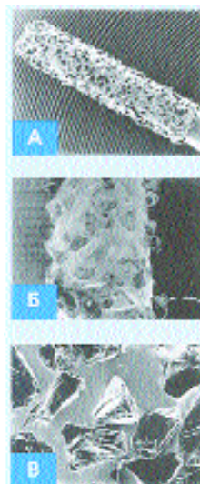
Рис. 1. Поверхность алмазного бора при различном увеличении: А – 26 кратное; Б – 100 кратное; В – 207 кратное
